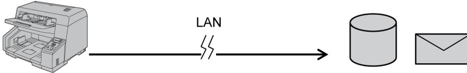
如果已配置扫描服务器，则会在需要的情况下通过扫描服务器将已扫描数据发送到目的地。扫描服务器会在后台自动运行。因此，您无需在扫描时选择扫描服务器。
