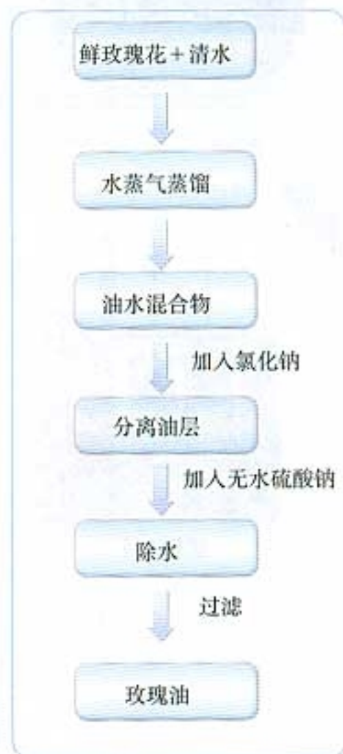
图6-1 提取玫瑰精油的实验流程示意图
