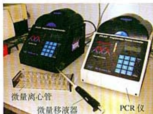
图 5-8 PCR 仪、微量移液器和微量离心管
