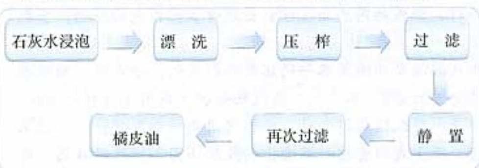
图6-4 提取橘皮精油的实验流程示意图
