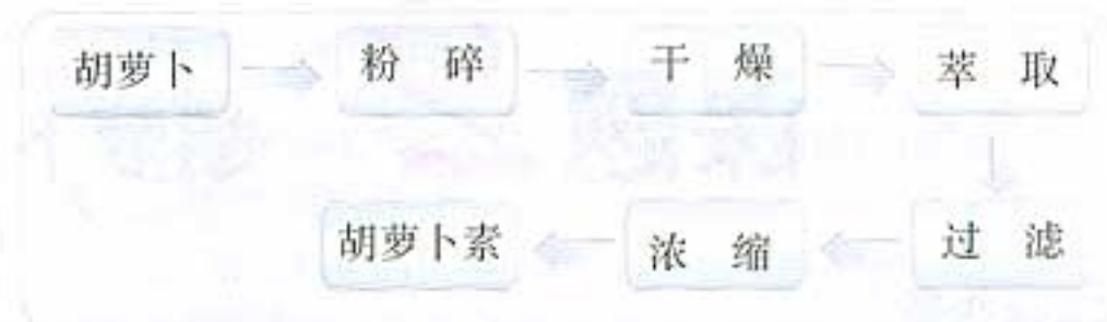
图 6-6 提取胡萝卜素的实验流程示意图
