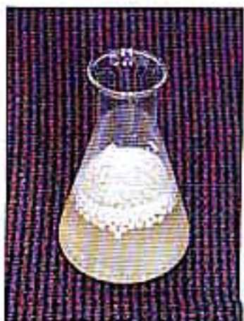
图4-13 用固定化酵母细胞发酵葡萄糖溶液
