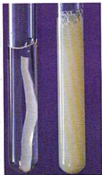
图 2-12 纤维素酶水解滤纸试验，右边的试管中加入了纤维素酶，而左边的没有加入
