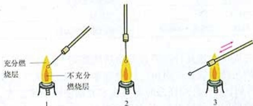
图 2-2 接种环的灼烧灭菌(1、2、3表示先后顺序)
