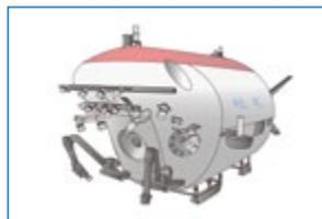
“蛟龙号”潜水艇最大下潜深度达七千零六十二米。
