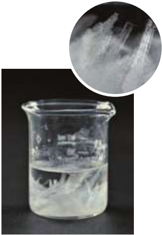
图 9-10 冷却热的饱和溶液时，硝酸钾晶体从溶液中析出
