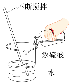
图 10-5 浓硫酸稀释的正确操作
