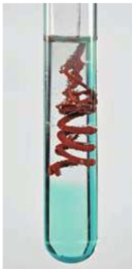
图8-13 铝与硫酸铜溶液的反应
